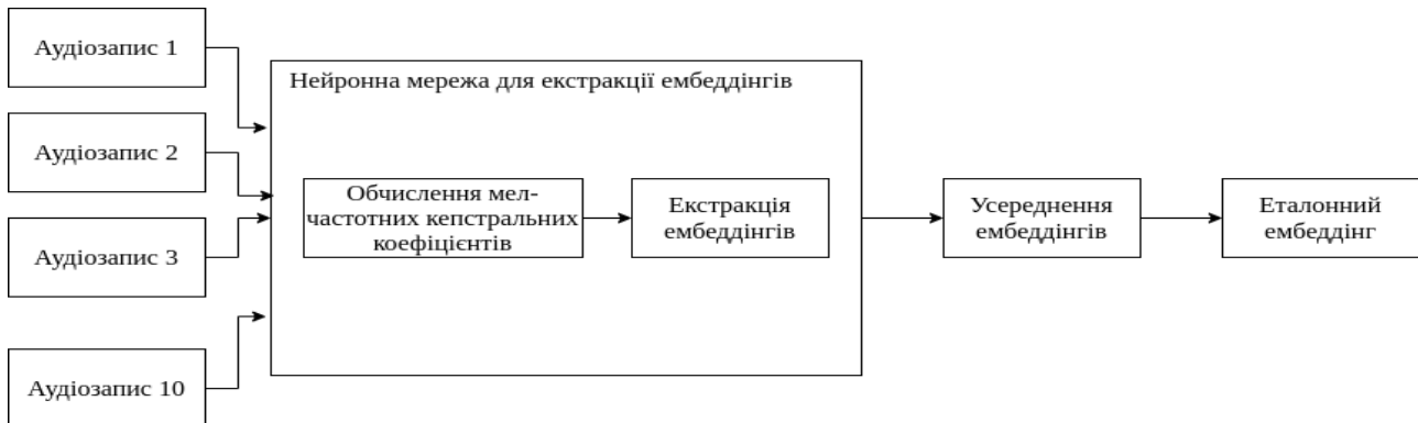
Рисунок 1. – Схема модуля реєстрації системи біометричної автентифікації
