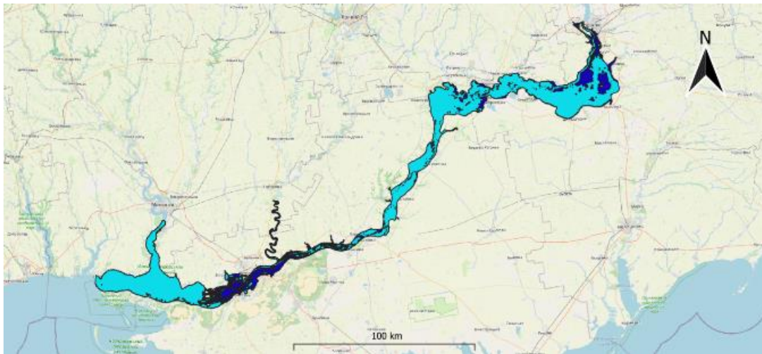
Рисунок 3 – Загальні прогнозовані зони затоплення для умовного сценарію прориву ГТС: блакитним – початкові умови моделювання, синім – зони затоплення в наслідок прориву
