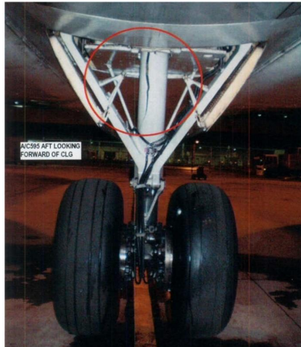
Рисунок 1 – Негативний вплив водневого окрихнення на шасі авіаційної техніки
