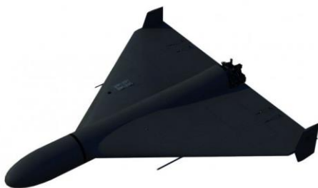
Рисунок 2 – Баражуючий далекобійний боєприпас Shahed-136 (Іран), побудований за схемою “літаюче крило”
