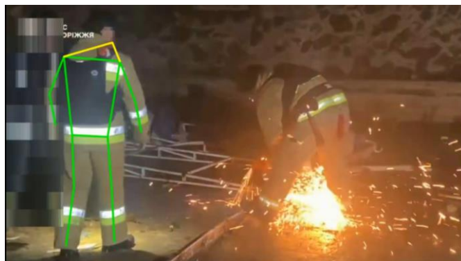
Рисунок 5 – Фото ергономічного дослідження ризиків рятувальників під час виконання аварійно-рятувальних робіт у м. Запоріжжя, з використанням болгарки
