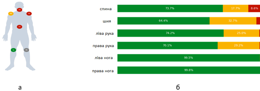
Рисунок 10 – Рівні ризиків за частинами тіла рятувальників під час виконання аварійно-рятувальних робіт у м. Мирноград, Донецької обл. після обстрілу: а – група ризику за частинами тіла та б – розподіл часу за ризиком положення тіла
