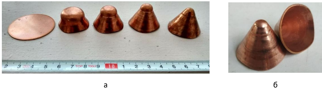
Рисунок 27 – Результати витягування напівфабрикату кумулятивного облицювання: а – технологічні переходи витягування напівфабрикату, б – вигляд напівфабрикату після витягування
