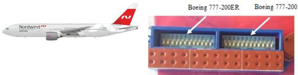
Рисунок 8 – Літак Boeing B777-200ER зі схемою перемикування контактів блоку обробки кількості палива для Boeing 777-200ER та Boeing 777-200 [13]
