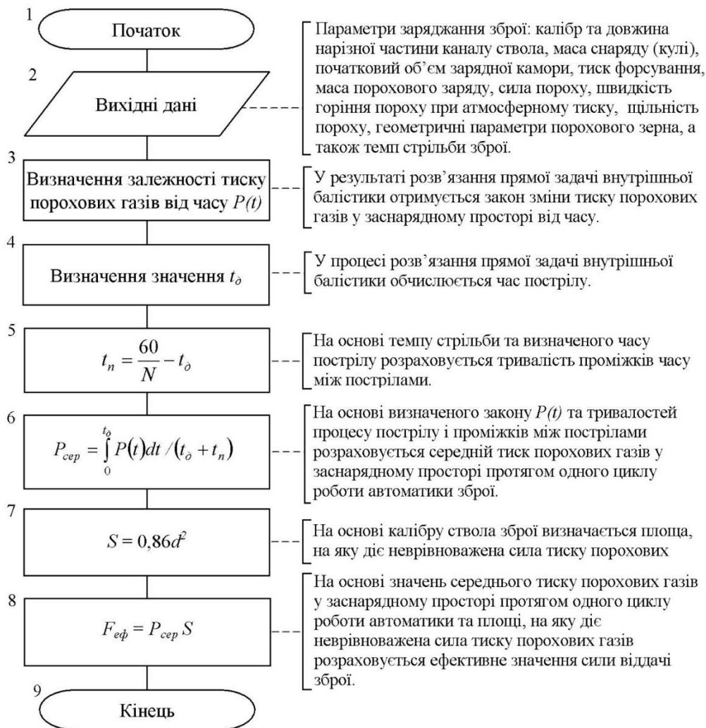
Рисунок 6: Блок-схема алгоритму визначення ефективного значення сили віддачі автоматичної зброї
