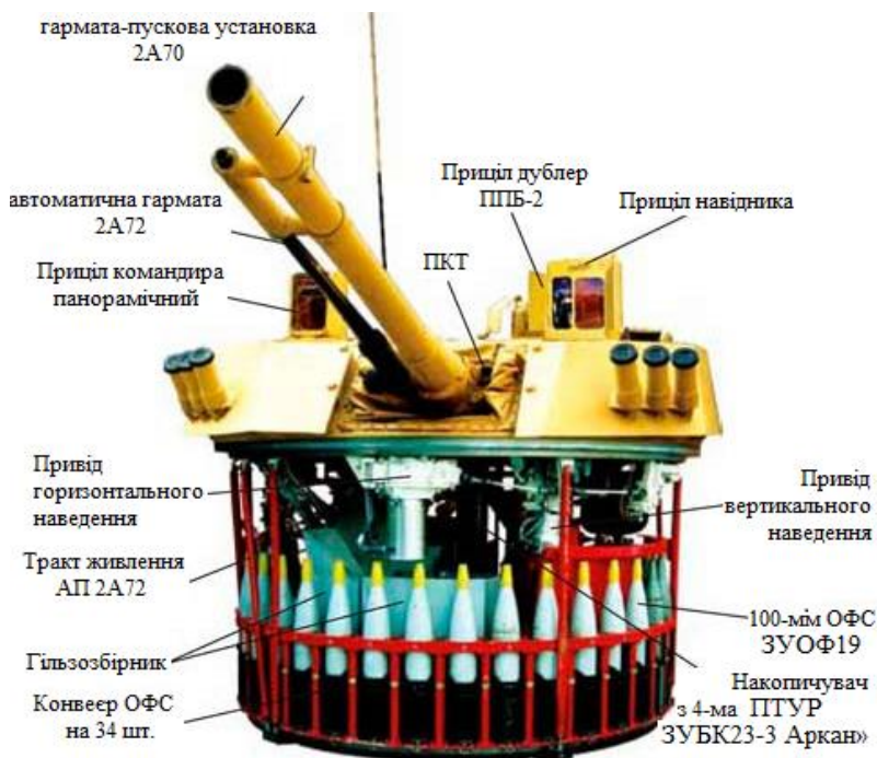
Рисунок 4 – Загальний вигляд та основні ТТХ Бойового модуля Б8Я01 “БАХЧА-У”
