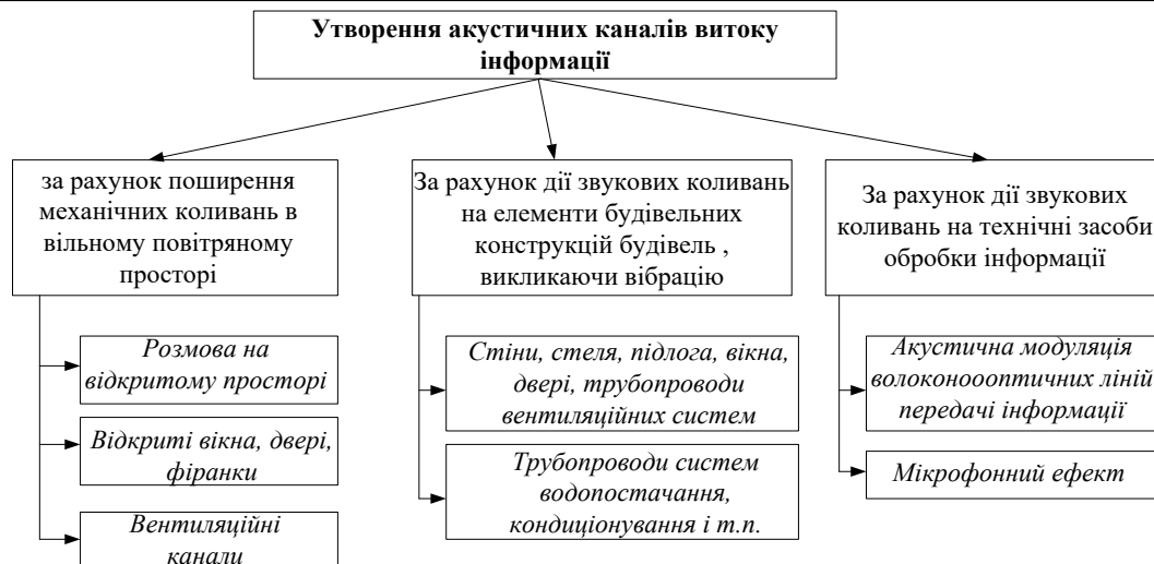
Рисунок 1 – Утворення акустичних каналів витоку інформації
