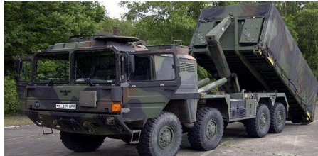
Рисунок 3 – Машина-самонавантажувач, оснащена обладнанням типу “мультиліфт”
