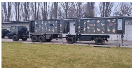
Рисунок 5 – Автоконтейнеровоз, обладнаний гідравлічними вантажно-розвантажувальними пристроями
