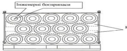
Рисунок 7 – Контейнер для перевезення та зберігання інженерних боєприпасів [29]
