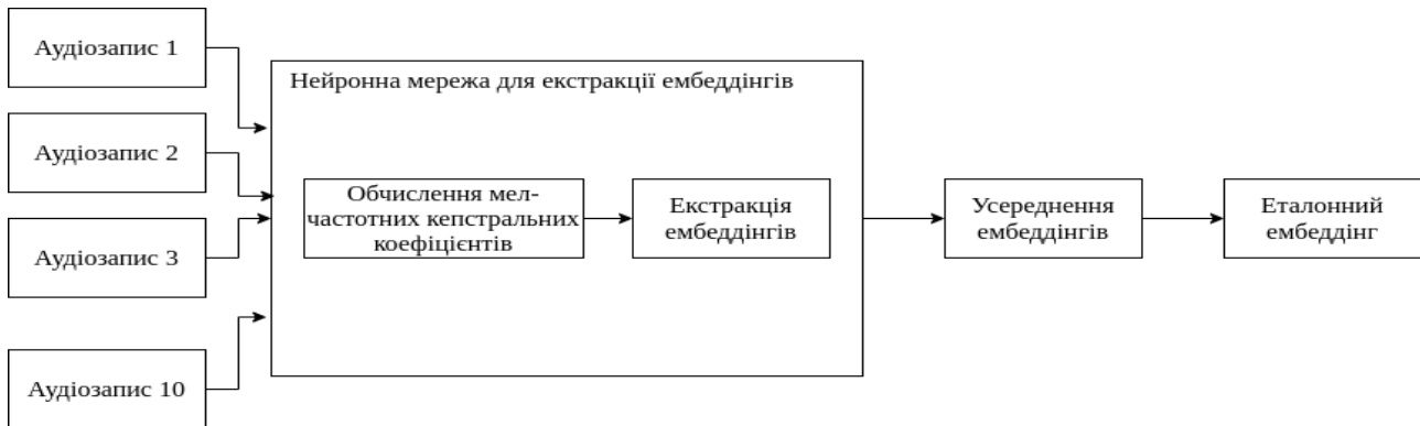
Рисунок 1. – Схема модуля реєстрації системи біометричної автентифікації
